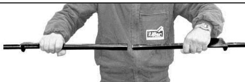
3. Anbring stangen (Del 2) under maskinen og sæt den fast med de omega Formede bøjler (Del 1) som vist på figuren. Fastspænd med de medfølgende skruer (del 14-15-16) og luk støtterøret ved at følge indikationen ved punkterne a), b) eller c) nedenfor. Sørg for at anbringe stangen således, at det bliver muligt at løfte generatorenheden så nemt som muligt. Man skal desuden kontrollere at stangen ikke er anbragt for lang tilbage for at undgå at maskinen vælter.
